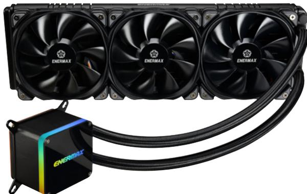
安耐美 LIQTECH II 系列，是一款通用于 Intel® / AMD® 的 CPU 水冷散热器，专为高阶处理器而设计。凭借 TDP 500W+ 的高冷却能力，可使 LIQTECH II AIO 水冷散热器即使在极端超频条件下也能提供卓越、可靠的冷却性能。除此之外，LIQTECH II 具备 Addressable RGB 导光圈水冷头，可支持新款 addressable RGB 主板同步提供亮丽的灯光效果。LIQTECH II 是 CPU 超频主机、绘图工作站、服务器之优选。
